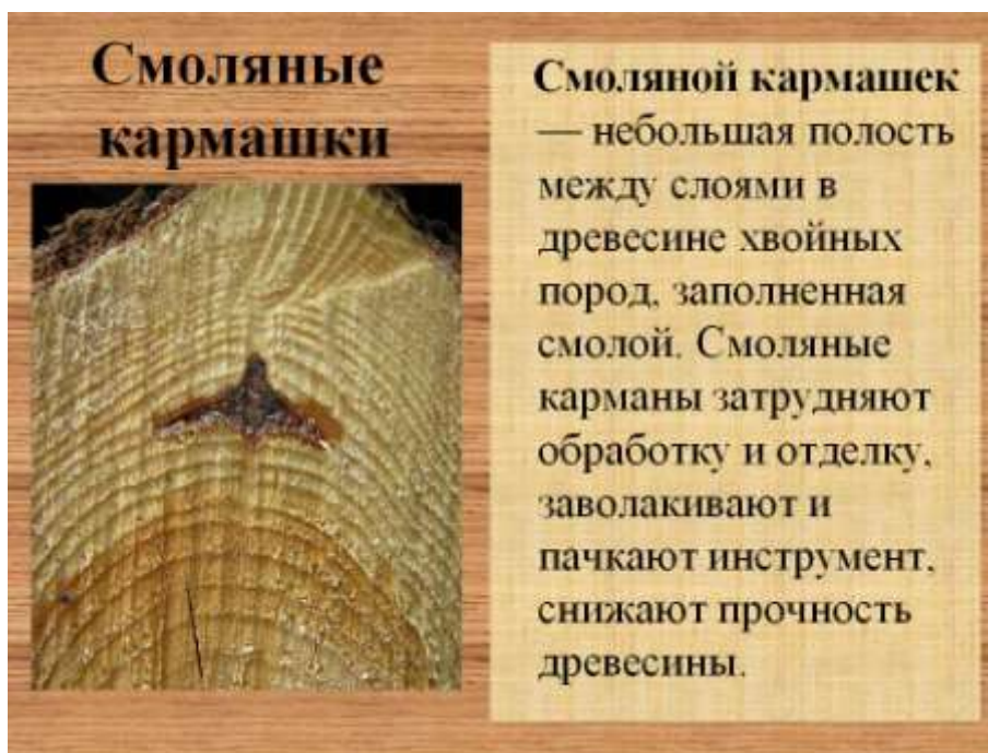
Рис. 5 Смоляной кармашек древесины
