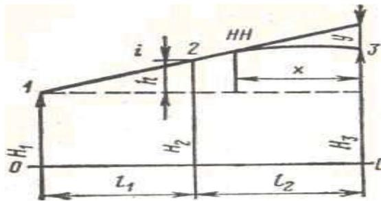
Вычисление проектных отметок, расположенных на кривой. Радиус подбирается в каждом конкретном случае по шаблону. Уклоны в точках начала и конца кривой определены как уклоны прямых участков. Пикетажное положение точки начала кривой определяется по профилю. Значение проектной отметки точки начала кривой определяется как проектная отметка на прямой.
