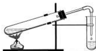
Рис. 32. Получение уксусной кислоты.
